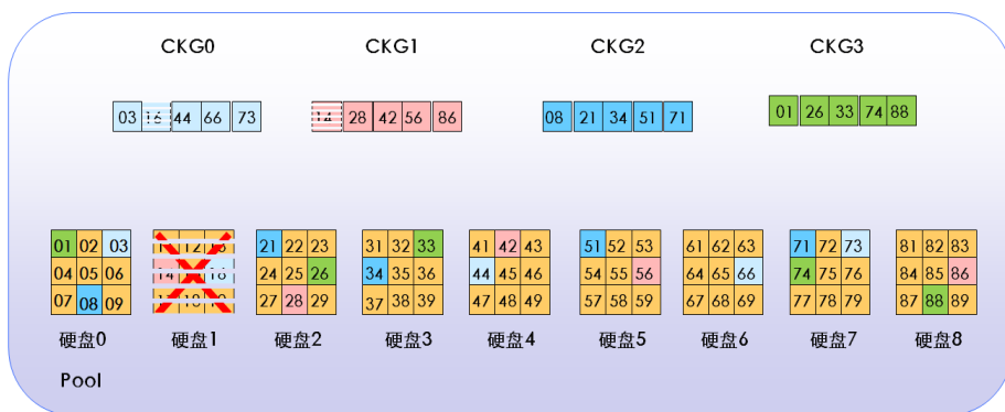
图1-38 RAID2.0+快速重构示意图（一）
