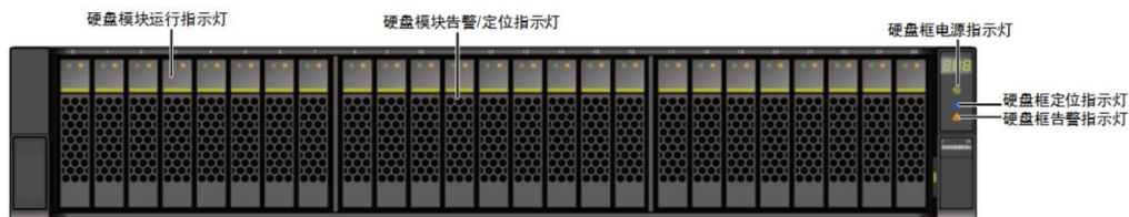
图1-27 硬盘框前面板指示灯
